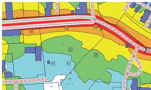
Utdrag ur bilaga 1 till trafikbullerutredningen (WSP) - Ekvivalent ljudnivå, nuläge. Gult fält visar på 50-55 dBA.
