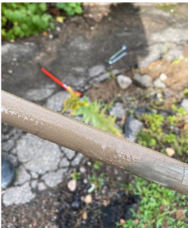
Figur 7. Provpunkt 22TY04P, påträffad fukt i samband med att spjutet drogs upp ur marken.
