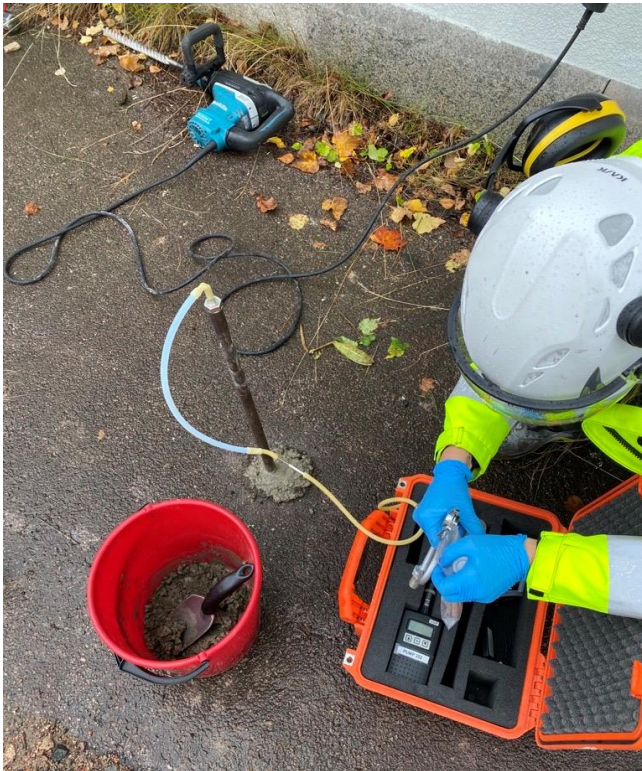
Figur 9. 22Ty06P provtogs i marken precis utanför pannrummet som var planerat för inomhusprovtagning under betongplattan.
