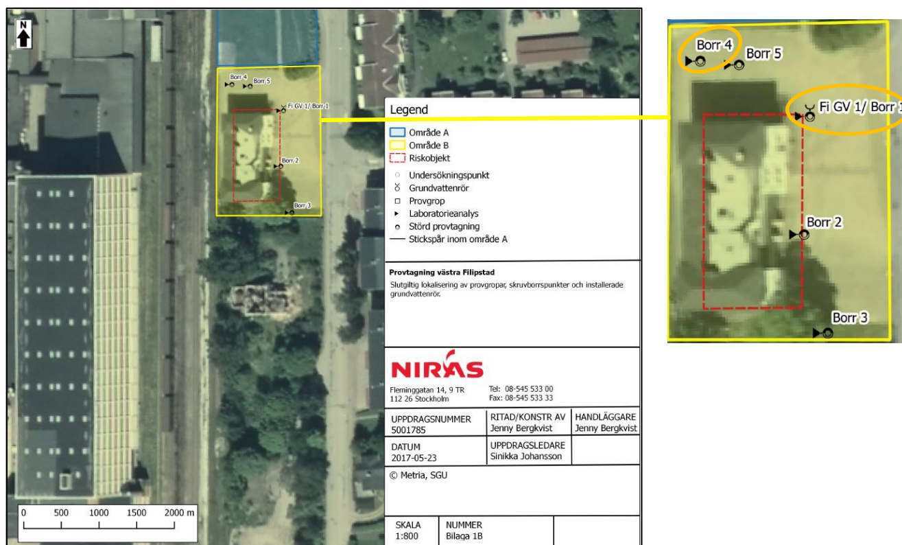
Figur 1. Bild hämtad från Niras rapport (Niras, 2017). Karta över stationshuset i Filipstad med de av Niras genomförda provtagningspunkterna i jord och installation av ett grundvattenrör (GV1) inom det södra delområdet (Område B). Provpunkterna markerade med orange innebär att halter har påträffats överskridande riktvärde för MKM i jord.
