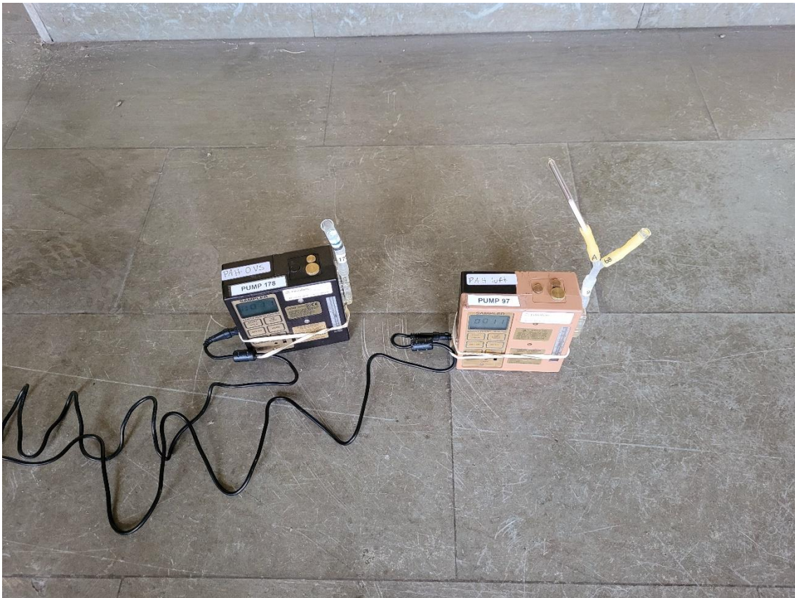
Figur 12. Bild på utställda luftpumpar för provtagning av inomhusluft (till höger i bild) och partikulärt bunden PAH (till vänster i bild). Bild från provtagning i punkt "Biljetthall" (Bilaga 1).
