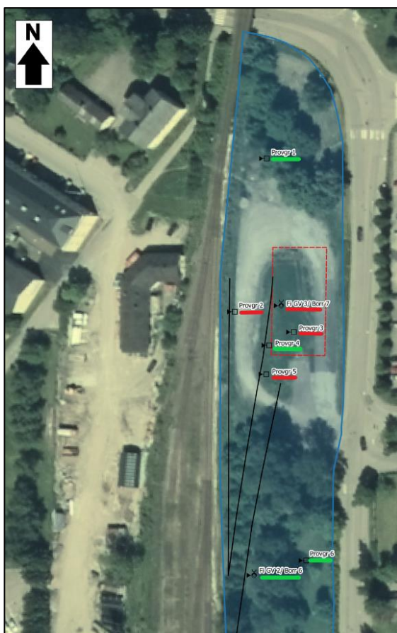
Figur 3. Norra delen av området. Provpunkter med föroreningshalter överskridande MKM markeras med rött. Grön färg är provpunkter under MKM. Modifierat urklipp av karta från Niras rapport, 2017.
